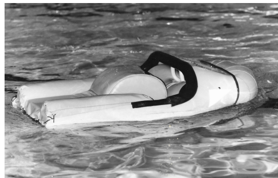
Modèle équipé de flotteurs revêtus de toile type zodiac
